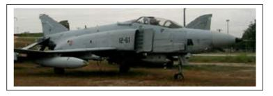
requiere la descontaminación previa del aparato, ya que todavía tiene en sus depósitos tonelada y media de carburante. Además, sus 20 metros de longitud, los 12 de envergadura y los 5 de altura nos dificultarán la tarea. Nos han asignado el CR. 12-52, al que correspondió el indicativo 12-61 del 123 Escuadrón del Ala 12, entregado al Ejército del Aire en enero de 1989.
