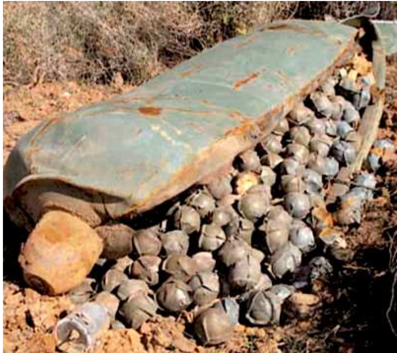
Deposito defectuoso que no se abrió en el aire.
